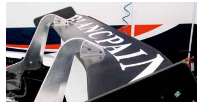
Sopra: i doppi terminali di scarico centrali. A sinistra: al centro del volante, oltre ai tasti di alcune funzioni, sono posti i pomelli di regolazione di ABS (verde) e traction control (rosso). Nella parte bassa della plancia il pomello (verde) del ripartitore di frenata. Sotto: l'ala posteriore regolabile, a profilo singolo con attacchi nella parte superiore. A sinistra: la Pirelli ha realizzato appositi pneumatici con la carcassa più rigida. In basso: la parte frontale ampiamente modificata con uno splitter e alette laterali per aumentare il carico aerodinamico e la parte superiore del cofano con le due bocche di sfogo dell'aria calda del radiatore.
